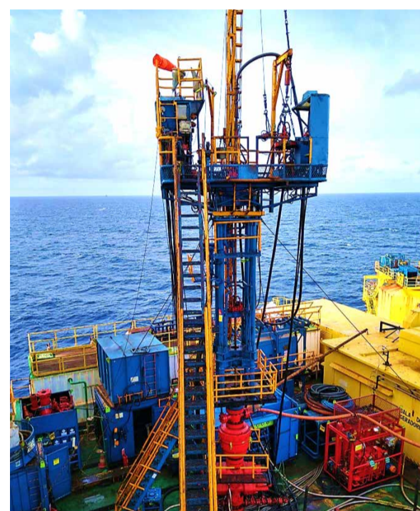
Sonda do tipo SPH instalada sobre válvula de poço em plataforma
